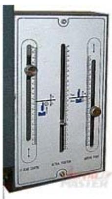
При помощи простых передвижных указателей, которые расположены на дополнительной панели, можно быстро задать высоту подъема ножа и установить границу переключения скорости подачи и рабочего хода пауансона.
