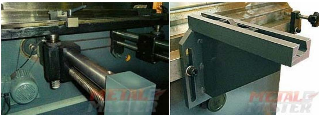
Во фронтальной части находятся кронштейны для поддержки металлических листов. На кронштейнах расположен регулируемый перекидной упор для облегчения точного расположения листа на матрице.
