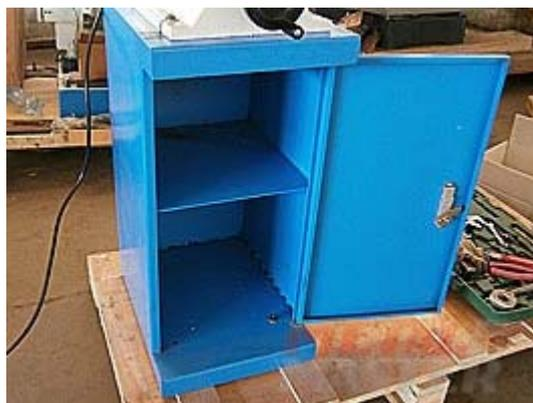
Крестовидный стол может перемещаться по направляющим и имеет миллиметровую линейку и передвижные упоры для ограничения. На столе предусмотрены крепежные пазы в форме Т. На тумбе находится запирающая дверца. Тумба разделена на две части при помощи горизонтальной полки.
