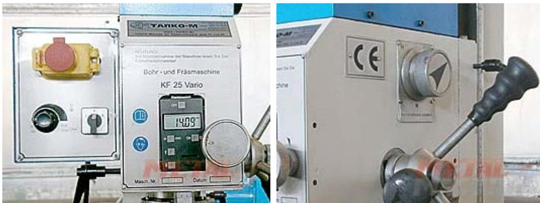
Сверлильный фрезерный станок отличается компактными размерами и оснащен мощным электродвигателем с двумя ступенями и вариатором для скоростей, что дает возможность плавно менять скорость вращения шпинделя.
