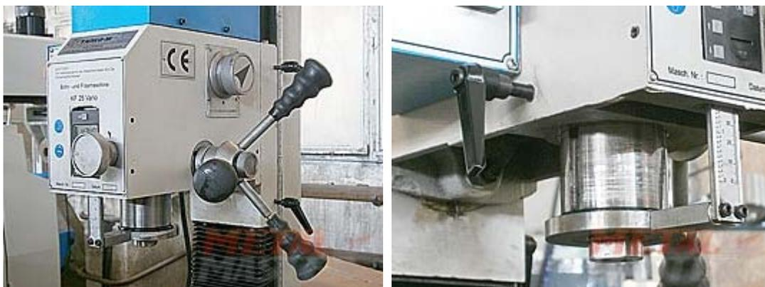
Ручка быстрой подачи пинולי имеет форму звезды. Ход пинולי отражается на линейке и индикаторе. Винт подачи оснащен лимбом со шкалой. С боковой части фрезы располагается фиксатор пинולי.
