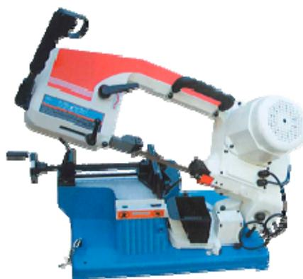
Ленточнопильный отрезной станок ручного типа с диаметром 100 мм и поворотом до 45 градусов является маятниковым станком с закреплением пильной рамы на консоли. Применяют такой станок для резки профильного металла. Пильная рама станка поднимается и опускается вручную.
