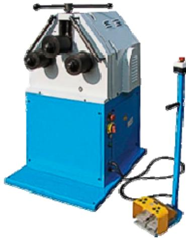
Профилегиб применяется для изгиба профилей разного сечения из металла. Используется при изготовлении теплиц, оград, декора, перил, козырьков.
