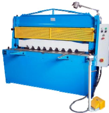
Комбинированный универсальный электромеханический станок объединяет в себе листогиб, гильотину и вальцы. Станок имеет жесткую сварную конструкцию с армированием, что делает машину устойчивой к износу.
