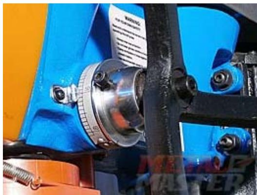
Пиноль поворачивается при помощи ручки в виде звезды. На станке также расположен указатель глубины сверления с выставлением точки отсчета.
