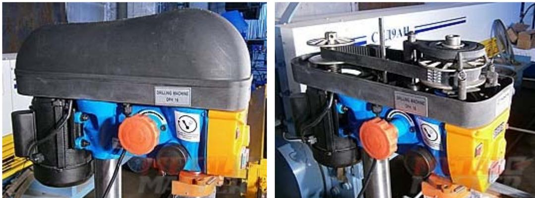
Плавный ход обеспечивается шкивами из алюминия и приводными зубчатыми ремнями. Скорость вращения может плавно регулироваться путем поворота ручки сбоку от сверла. Частота оборотов фиксируется на цифровом индикаторе.
