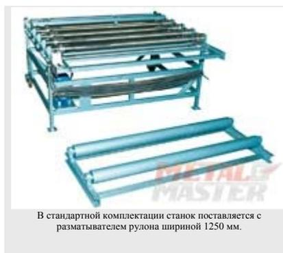
В стандартной комплектации станок поставляется с разматывателем рулона шириной 1250 мм.
