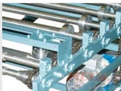
Усиленные валы обеспечивают высокое качество получаемого профиля. Калибровочные ролики для тонкой настройки на нужный тип металла.
