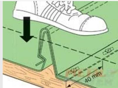
Для соединения кровельных панелей герметичным замковым соединением достаточно нажатия.
