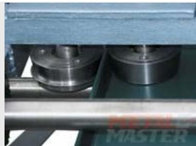
Регулировка степени зажима фальца позволяет осуществлять подстройку под металл разного типа и толщины.
