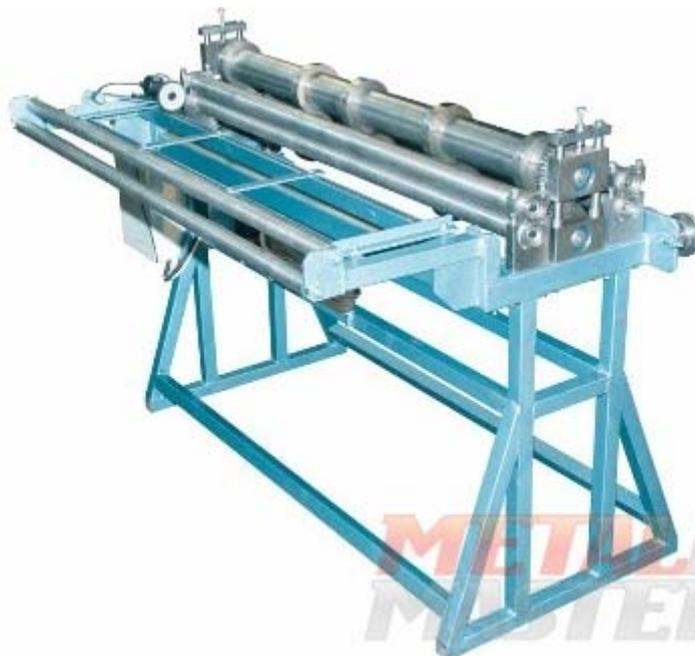
Смотчик рулона ДНМ-10 – имеет две опоры и используется для сматывания ленты в рулон при или после раскроя металла в рулоне. Намотчик может быть установлен в линию с размотчиком и станком для продольной резки. Конструкция с двумя опорами позволяет достичь высокой жесткости, что обеспечивает ровные рулоны по ширине и плотности. Для снятия рулонов после резки ось поднимается, вал снимается с опор, винт-гайка ослабляет прижим лепестков, и рулон снимается.
