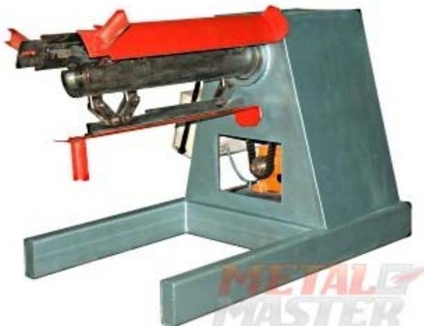
Станок продольно-поперечной резки СПР-1250/5-А – используется для продольной резки металла в рулонах и листах. Валы приводятся в действие электродвигателем при помощи цепной передачи. Максимальная толщина реза 1,5мм. Валы обеспечивают хорошую точность и качество реза. Станок оснащен дисковым ножом для поперечной резки.
